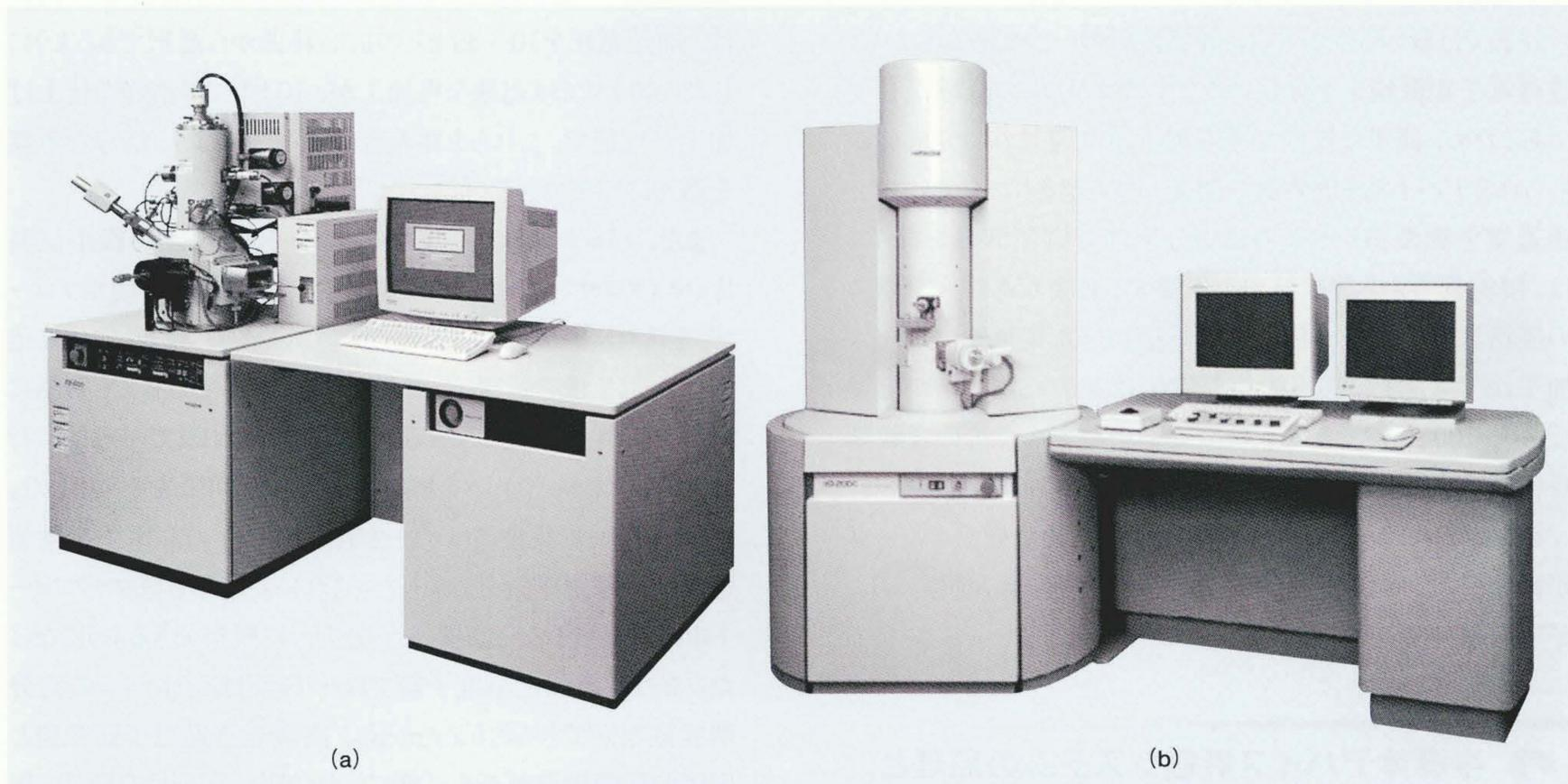
新開発の半導体デバイス評価システムを構成する集束イオンビーム加工装置“FB-2100”(a)と超薄膜評価装置“HD-2000”(b)
