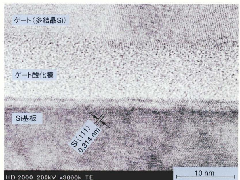
図6 評価システムを用いて薄膜化したSiデバイスゲート部の高分解能走査透過像観察例
