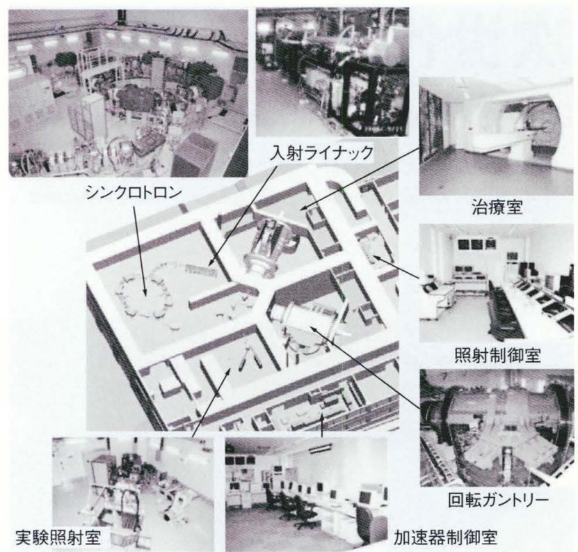
図1 筑波大学PMRCの陽子線治療システムの全体構成
