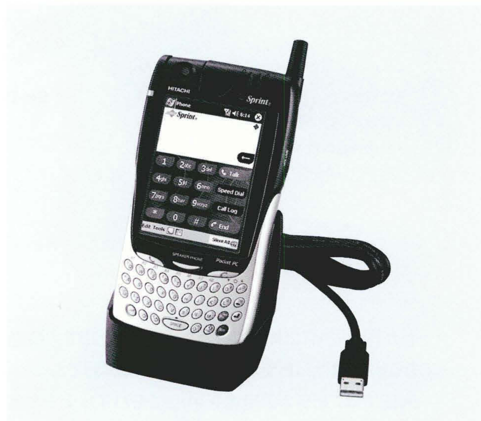
図1 SH-G1000本体とクレードル(スタンド形の拡張機器)
