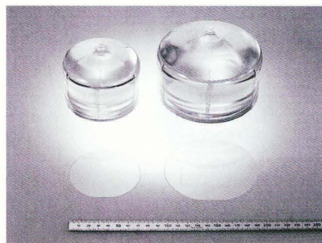
SLN単結晶とウェーハ[左列が約7.6 cm(3インチ)径、右列が約10 cm(4インチ)径]
