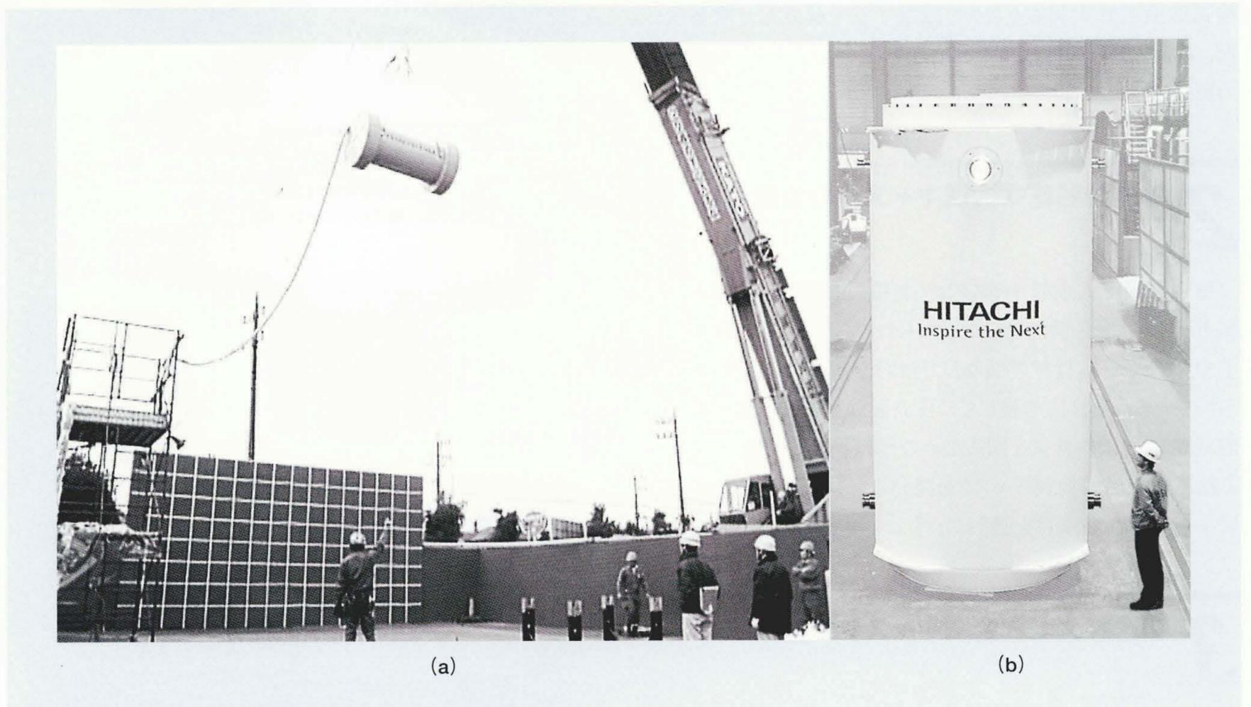
輸送貯蔵乾式金属キャスクの $\frac{1}{3}$ モデル落下試験(a)と実規模キャスクの外観(b)
