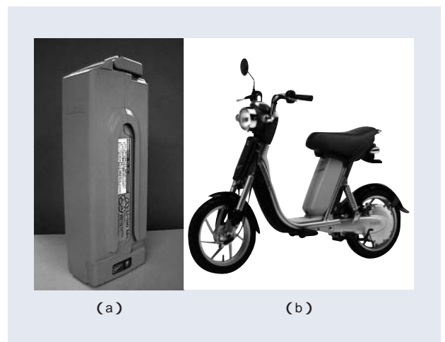
図4 軽車両用リチウム電池モジュール(a)と、ヤマハ発動機株式会社の電動スクーター「パッソル」(b)
