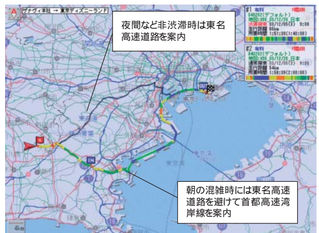
図7 統計交通情報を用いた経路探索例
