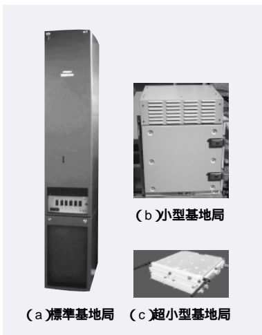
図2 各基地局の外観 さまざまなトラフィックに対応する基地局をラインアップしている。
