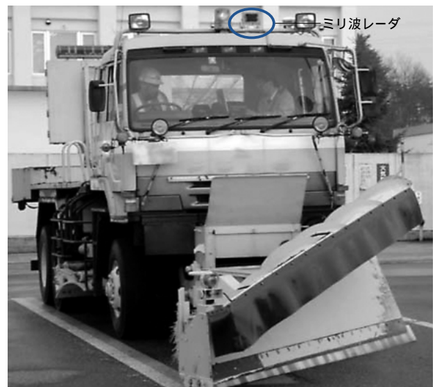
図5 除雪車への取り付け状況
