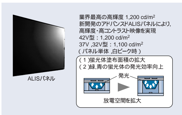
図4 新開発アドバンスドALISパネルの特徴
