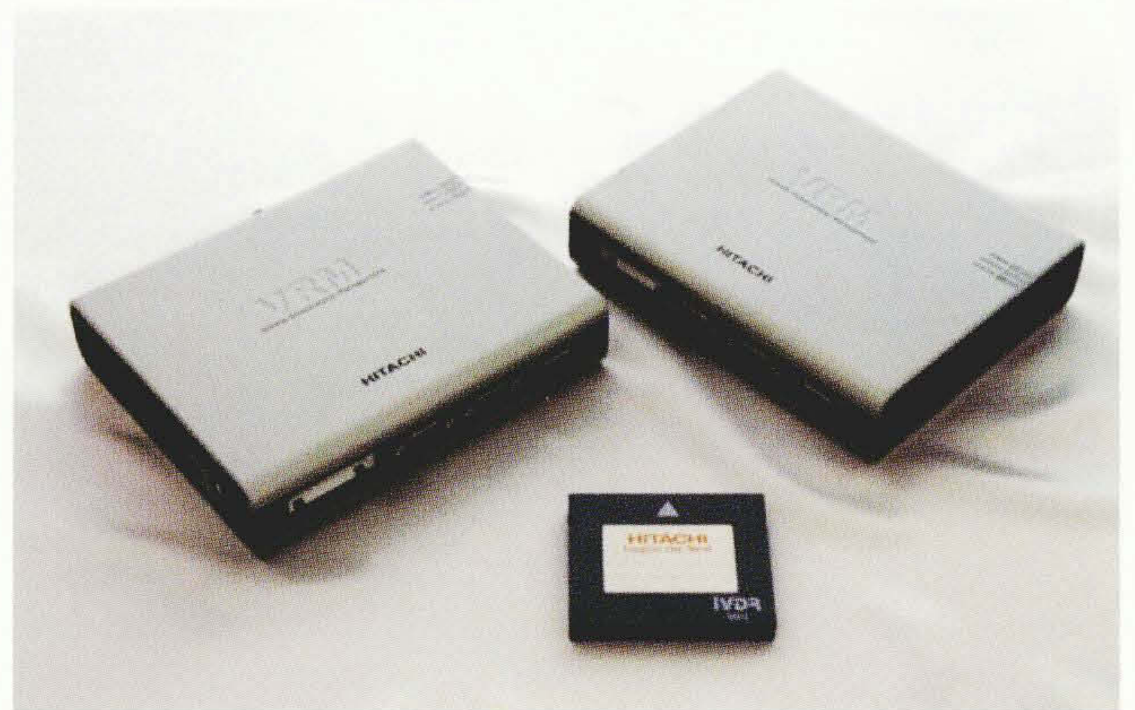
GPS (Global Positioning System)、ハード ディスク ドライブ、無線通信インタフェースおよび車内 LAN (Local Area Network) インタフェースを内蔵した VRM 端末試作機
