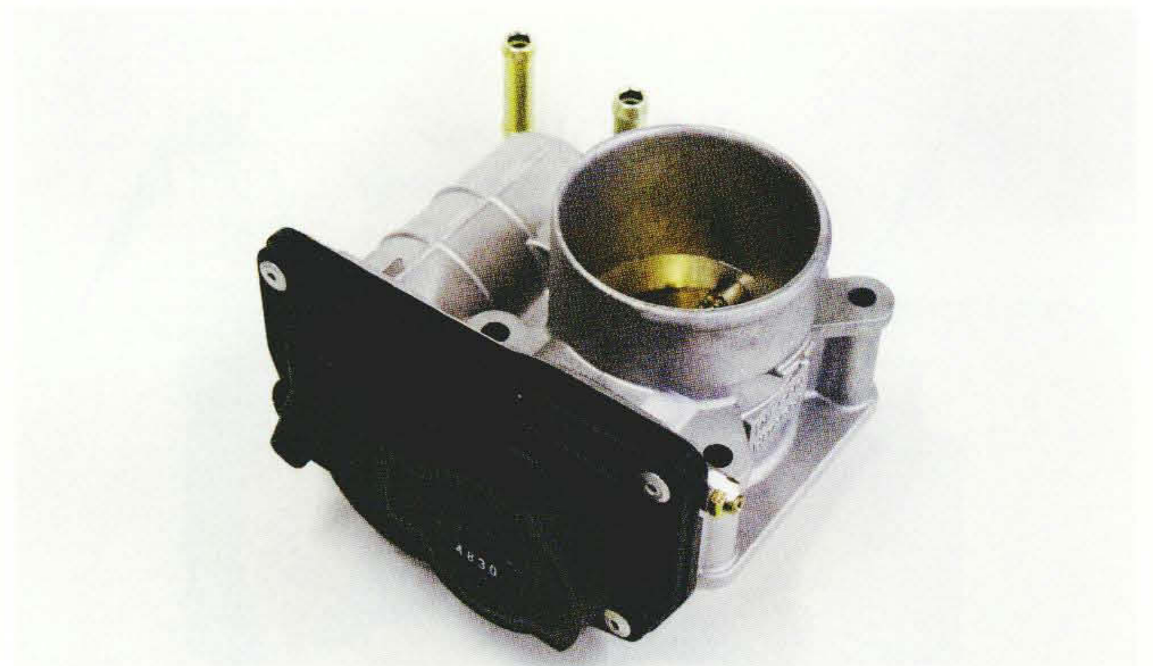
小型・軽量電子制御スロットルボディの外観
