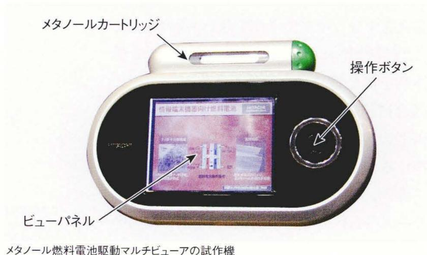
メタノール燃料電池駆動マルチビューアの試作機
