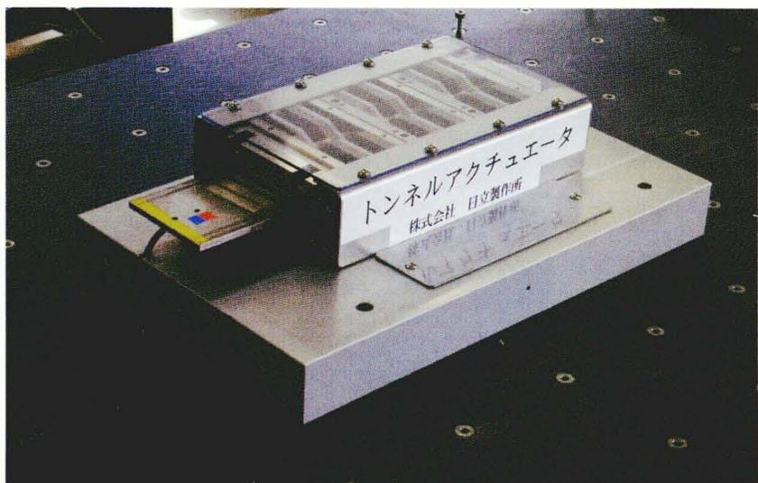
40 Gの世界最高加速度を実現したトンネルアクチュエータの試作機
