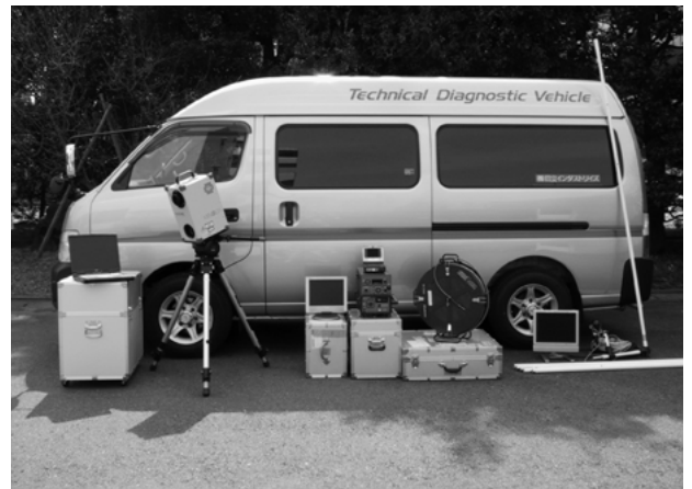
図9 移動診断車 ポンプ機場に向き、ポンプを分解することなく診断ができる。
