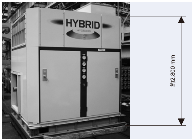
図10 横軸ハイブリッド原動機の外観 工場完成時の外観(仕様 350 kW×238 min -1 )を示す。
