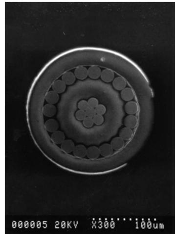
図3 極細同軸ケーブルの例
