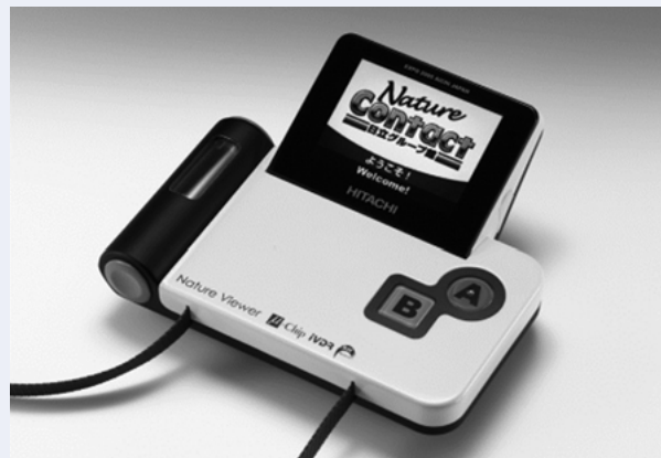
(b) メタノール燃料電池を搭載した携帯情報端末
