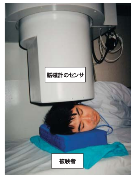
図5 脳磁計による脳磁図の測定の様子 心磁計とほぼ同型の脳磁計を用いて、頭部の脳磁図を測定する。
