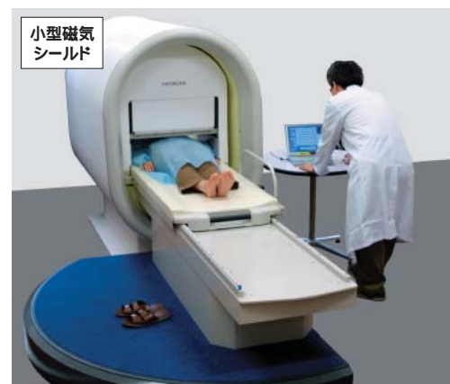
図2 可搬型心磁計装置の外観 小型磁気シールドとその内部にある高温超伝導体を用いたSQUID(Superconducting Quantum Interference Device:超伝導量子干渉素子)により、小型化を実現している。
