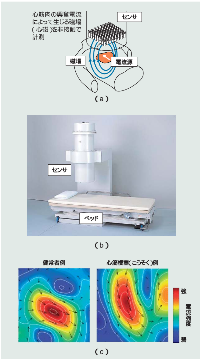
図1 「心臓磁気計測システム（心磁計）の原理と装置の外観 心磁計の原理図を(a)に示す。微弱の心臓磁場を64チャンネルの超高感度磁気センサで計測し、心磁図として表す。(b)は株式会社日立ハイテクノロジーズで製品化した心磁計「MC-6400」の外観である。健康者と心筋梗塞患者の心磁図(c)は、心臓全体がマップで示されるので視覚的にわかりやすいという特徴を持っている。
