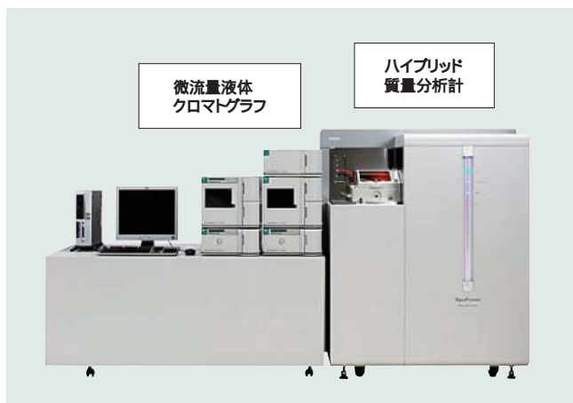
図3 プロテオーム解析用質量分析システム“NanoFrontier”の外観。微量液体クロマトグラフで分離した試料をイオン化して、ハイブリッド質量分析計で検出する。
