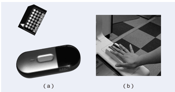
図3 KeyMobileとKeyMobile読み取り装置(a)、指静脈認証装置の外観(b)
