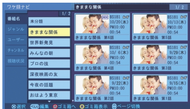
図3 「ワケ録」ナビゲーション表示画面例 「ワケ録」操作時の表示画面を示す。左端を第一階層とし、分類の種別を選択する。分類種別として「番組名」を選んだ場合、第二階層に番組名ごとのフォルダ形式を表示し、選択したフォルダに含まれる番組を右側に6番組サムネイル表示する。
