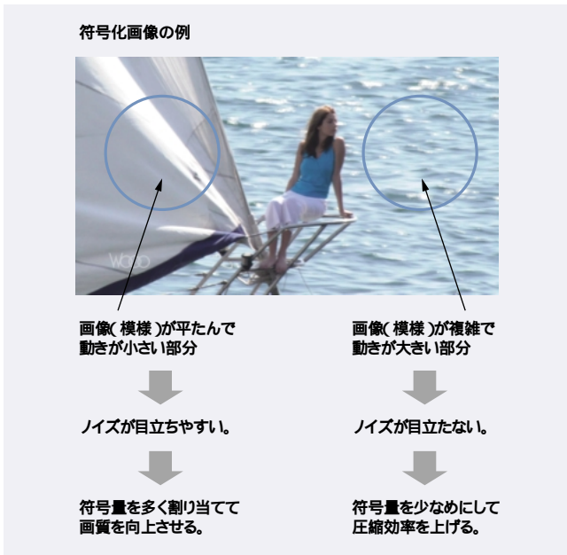
図3 H.264/AVC高画質符号化方式の概要 自然画像には視覚的にノイズが目立ちやすい箇所とそうでない箇所があり、これを判別して符号量を割り当てることによって映像を高画質に符号化できる。
