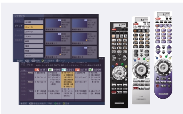
図5 ユーザーの実使用評価のためのプロトタイプ案の例 さまざまな考え方の製品案をプロトタイプ化して、高齢者や障害者を含むユーザーの使用評価を製品仕様に反映している。
