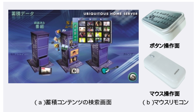
図6 ネットワーク環境での直感的なインターフェース案の例 情報が収納されている「情報庫」をビジュアル化したGUI(Graphical User Interface)の検索画面を(a)に、画面操作のスピードを向上させた「マウスリモコン」を(b)にそれぞれ示す。
