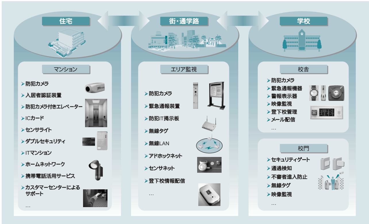
図1 生活空間におけるセキュリティシステムのイメージ マンションなどの住宅や学校, 通学路など 安全・安心 を支えるために必要なセキュリティ要素技術を示す。
