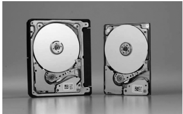
図6 Microdrive 3K8と従来モデルとのサイズ比較 Microdrive 3K8を右に、従来モデルのMicrodrive 3K6を左に示す。Microdrive 3K8はコネクタを小型化し、フットプリントを23%縮小している。新モデルのコネクタは裏側にある。
