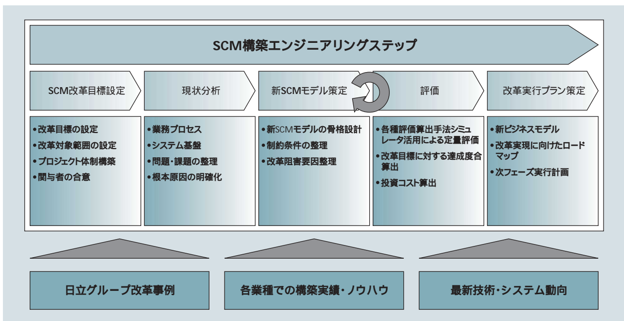
図6 SCM構築エンジニアリング SCM改革の成功に向けたプロジェクト企画段階から支援している。シミュレータを活用して新しいSCMモデルを定量的に評価し、合意形成、意思決定を支援している。
