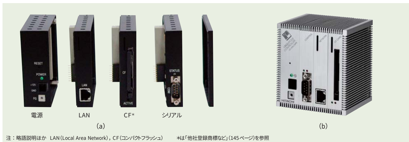
UbiCubeコンポーネントのシステム試作構成(a)と、試作機(アルミケース、約10 cm角)(b)
