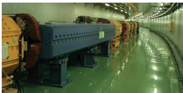
トンネル中に設置された50 GeVシンクロトロン電磁石
