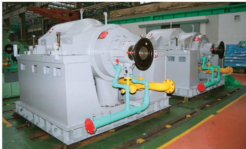
タービン駆動ボイラ給水ポンプの外観と仕様
