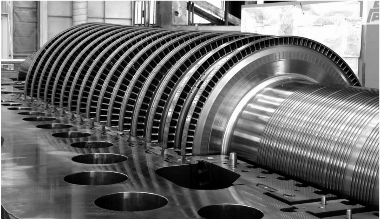
図1 韓国K Power社KwangYang Combined Cycle Power Plant向け200 MW蒸気タービンの高圧タービン部 高圧タービンロータをケーシング下半部に組み込んでおり、高圧タービンには日立製作所が新規開発した最適反動翼が全段落に採用されている。
