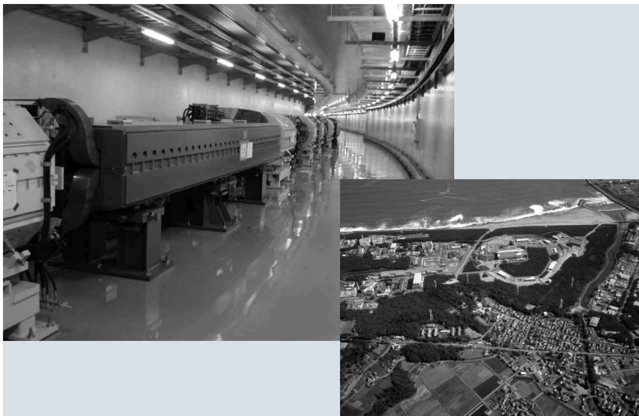
図1 50 GeVトンネル内に据付けられた電磁石(左)と、建設中の大強度陽子加速器施設 J-PARC (右)
