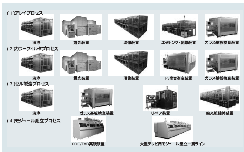
図4 主要な液晶パネル製造・検査装置 アレイプロセスから最終のモジュール組立プロセスまで各種製造・検査装置をラインアップしている。
