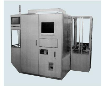
図6 NS7000シリーズ表面検査装置
