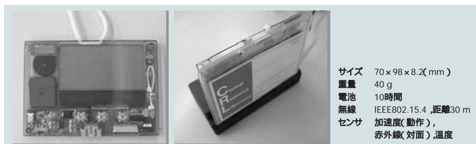
図2 「ビジネス顕微鏡」の名札型センサノード PCに接続された基地局と無線通信によりデータを転送する。自席に置かれたクレードルで充電する。
