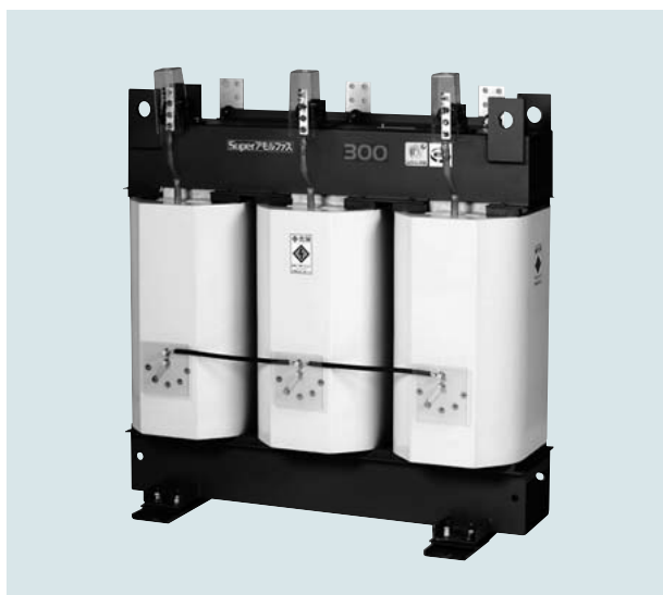
図4 アモルファス変圧器「Superアモルファスモールドシリーズ」の外観 三相、容量300 kVA、電圧6,600/210 Vのアモルファス変圧器の外観を示す。無負荷損245 W、負荷損394 W(負荷率40%)の超低損失変圧器である。
