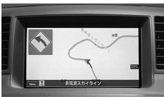
図8 自車位置精度を向上したカーナビゲーションシステム 自車位置を正確に把握できるのでブレーキなどの協調制御が可能となる。
