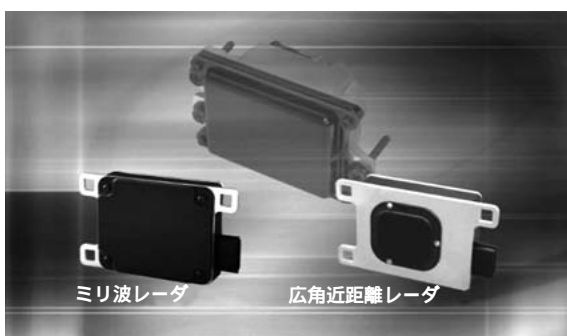
図7 日立ミリ波レーダ 日立ミリ波レーダはコンパクトな構造であり、小型化が容易で信頼性にも優れる。
