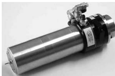
図2 毎分35万回転スピンドル 毎分35万回転スピンドルの外観を示す。
