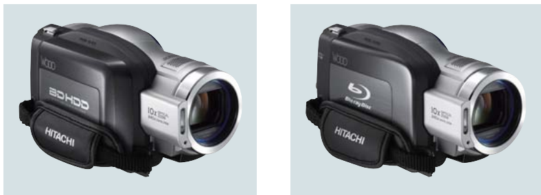
図4 世界初BD搭載「ハイブリッドBDカム」Wooo DZ-BD7H (左)とWooo DZ-BD70 (右) 美しい映像にこだわり、キーデバイス(レンズ、センサー、信号処理LSIおよび8 cmBDドライブ)すべてを新規開発し、フルハイビジョン映像をBDに約1時間、内蔵HDDに約4時間という長時間録画を実現した。
