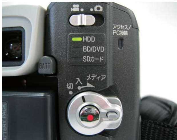
図7 BDカムWoooの新型モードスイッチ部 モードスイッチは操作しやすくするために指の移動量を少なくした。
