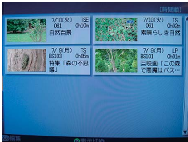
図6 「XR01」の録画番組一覧表示 サムネイル画像を表示することで各コンテンツの録画内容が把握しやすい。規格化されているため、外部機器でも同じ画像を表示可能である。
