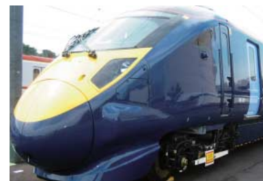
図11 英国海峡線向け高速車両(Class 395) A-trainコンセプトの下に開発した軽量化、高速化技術を英国仕様に適合させた。
