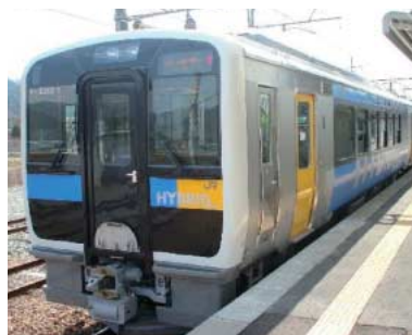
図4 JR東日本のキハE200形気動車 リチウムイオン二次電池を応用するハイブリッド駆動システムをJR東日本と共同開発した。
