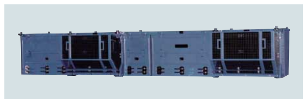
図3 VVVFインバータ装置の外観 VVVFインバータ装置の外観を示す。車体片側から取り扱えるように「長手箱構造」としている。
