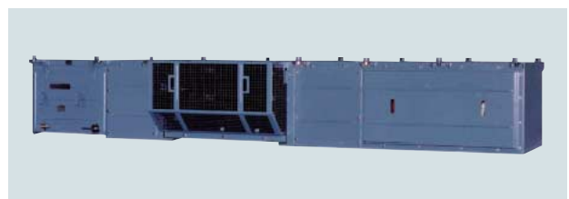
図4 補助電源装置の外観 補助電源装置の外観を示す。並列運転制御方式を採用し、三相出力線を常時接続しているため、1台の補助電源装置が停止した場合でもすべての車両が停電することはない。
