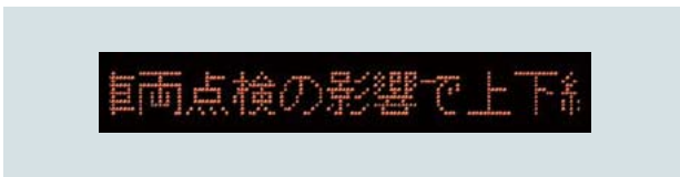
図6 LEDディスプレイにおける運行情報表示 一度に表示される文字数が限られるため、一見ただけでは情報を読み取ることが難しい。
