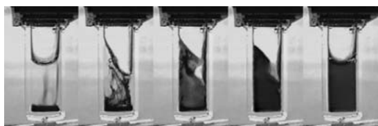
図3 反応液の非接触攪拌 色素により着色した水溶液を、特別に撮影用の反応槽および反応容器を用いて攪拌して、高速度撮影したものである。
