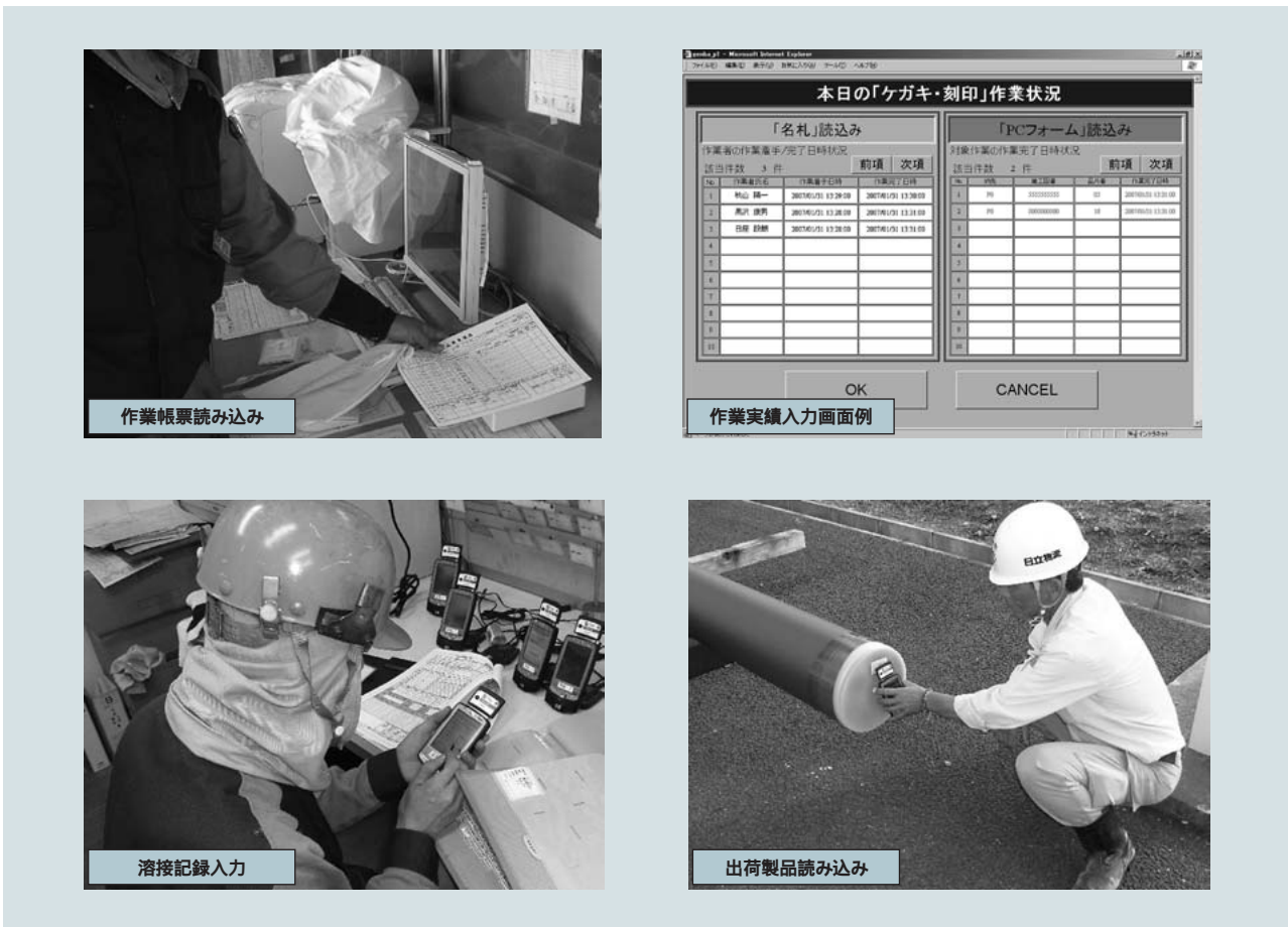
図3 配管製造工場でのRFID適用作業風景と入力画面の例 RFIDを配管の作業実績収集や溶接管理，出荷管理に適用している。
