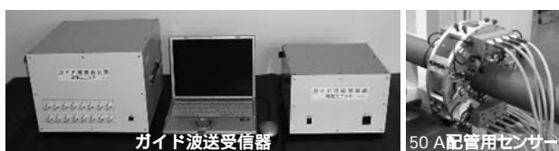
図7 ポータブルガイド波検査システム ポータブルガイド波検査装置外観と配管の測定状況を示す。
