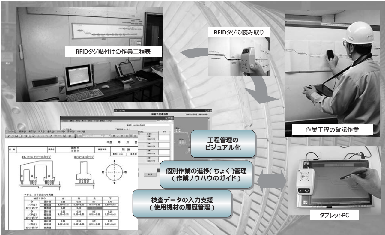
図1 東京電力株式会社納め「定期点検支援システム(工程管理・検査記録管理)」の概要
