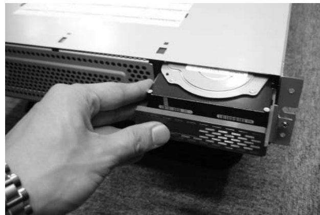
図4 リペアスロットへのHDD挿入 装置前面に設けられたリペアスロットへHDDを挿入すると自動的に障害復旧動作を開始する。
