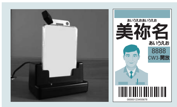
図6 無線タグと充電器,ラベルのイメージ
