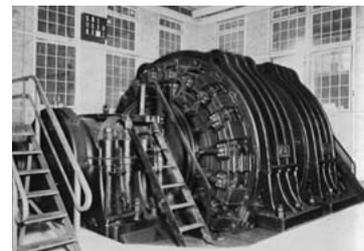
[8] 八幡製鉄所納め圧延用直流電動機
