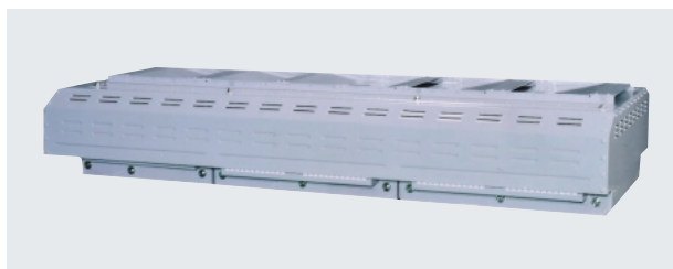
図4 蓄電池箱の外觀 車両の屋根上に搭載されるので、直射日光による機器の温度上昇抑止のために遮熱板を設けている。
