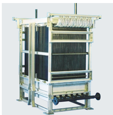
図8 浸漬平膜ユニット 膜ユニット下部に散気装置を設置して、散気することで膜面の閉塞(そく)を防止する。
