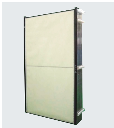
図7 PVDF(ポリフッ化ビニリデン)平膜カセット 膜面積1 m 2 の平膜エレメントを10枚束ねて構成している。
