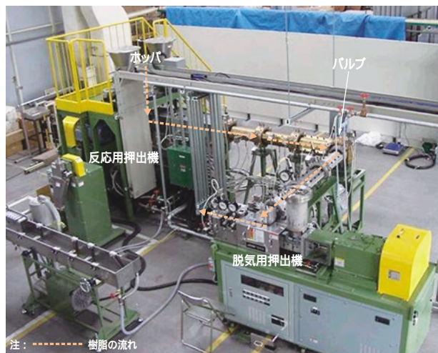
図7 シラン架橋ポリエチレン連続処理装置の外観 超臨界アルコールとプラスチック用押出機を組み合わせたシラン架橋ポリエチレン連続処理装置の設備外観を示す。
