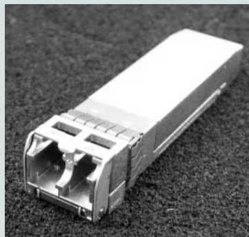
10 Gビット/s伝送を可能にするSFP+ 光トランシーバモジュール
