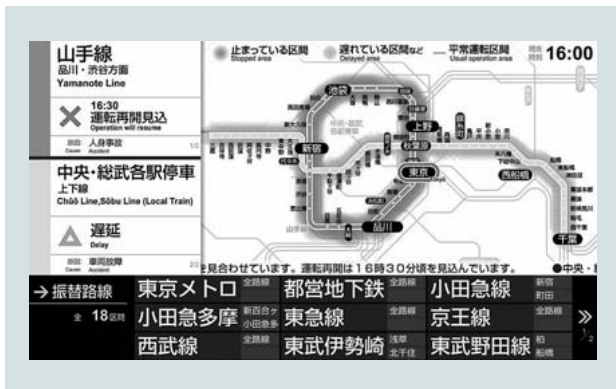
図3 異常時案内用ディスプレイの画面表示例 東日本旅客鉄道株式会社のディスプレイ画面表示例を示す。列車遅延などの運行情報を駅構内にあるディスプレイ画面の路線図上に表示し、利用者の視認性、理解容易性の向上を図っている。
